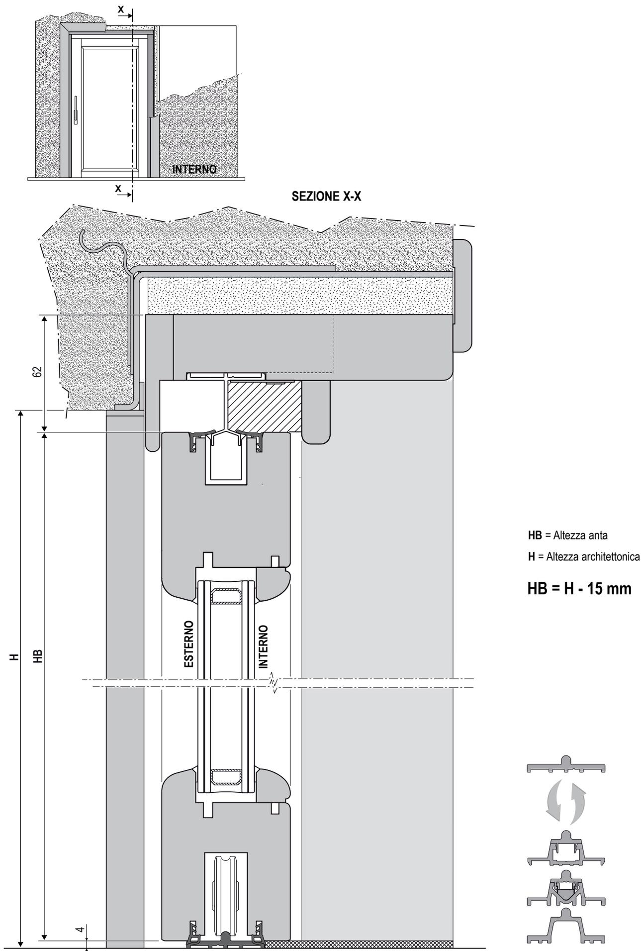
**Sezione orizzontale nodo lato serratura**
